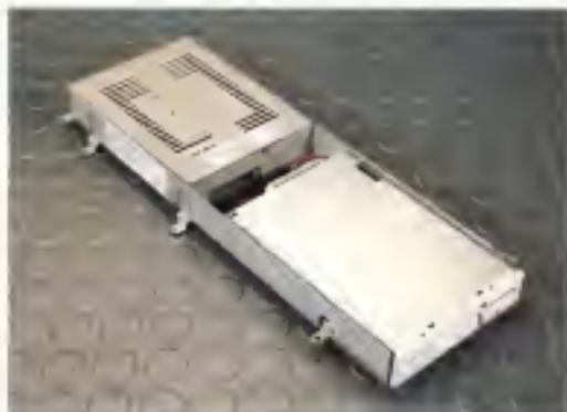
In alto: «il porta delle telecomunicazioni» il HD e il drive FD ben ancorati ad un unico struttura metallica. A lato: il processore ultraveloce è un veloce V30 della stessa NEC / no guarda!
